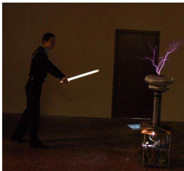
После включения устройства на свободном верхнем конце провода вторичной обмотки возникали стримеры длиной до 50см, а из-за искрения в воздухе появлялся запах озона. Работа резонансного трансформатора сопровождается характерным электрическим треском, появление которого связано с превращением стримеров в искровые каналы.
